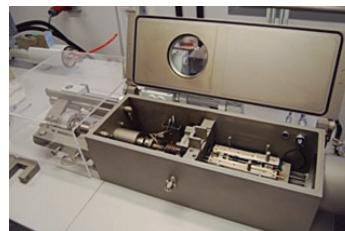
Dilatómetro de temple y deformación
